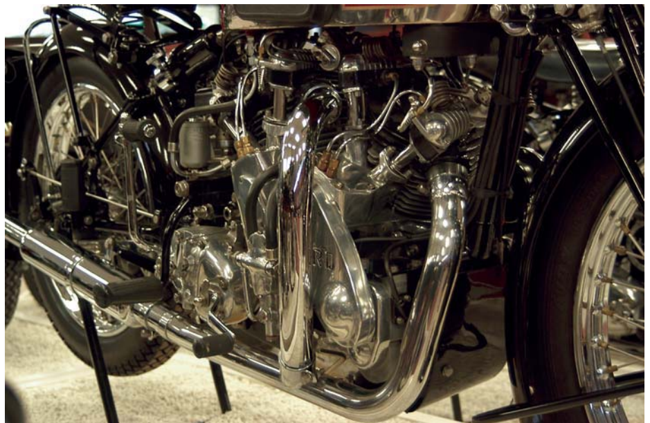
Hvem sa at finmekanikk tilhører våre dager? Dette er motoren fra en Vincent HRD fra 1937. 998 cc. og 45 hestekrefter. En fryd for øyet der den står på museet.
